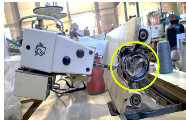
기존 재봉기에 설치된 크레센트훅 (위: 유니콘[브라더], 아래: 선스타 장착)
